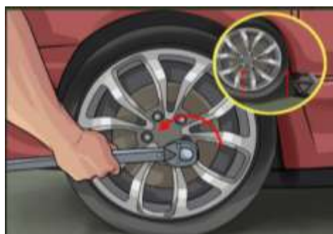
Figure2- 12 Loosen the lug nuts
